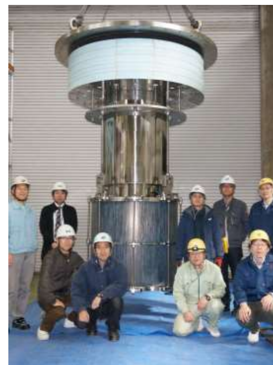
超伝導導体試験装置
