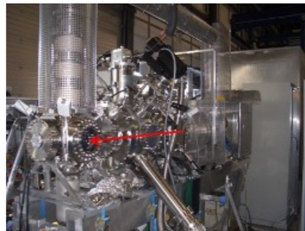
Max Planck-EBIT (EU) E_e < 200\text{keV} I_e = 550\text{mA}
