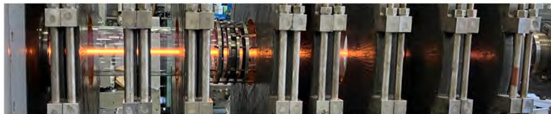
アーク放電によるHeプラズマ(放電電流~70A)
