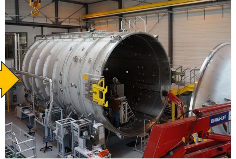
DLRスペースチャンバー 【内径5m, 長さ12m (稼働中)】
