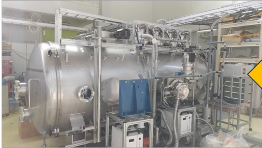
東北大学 スペースチャンバー 【内径1.5m, 長さ4m (改良中)】
