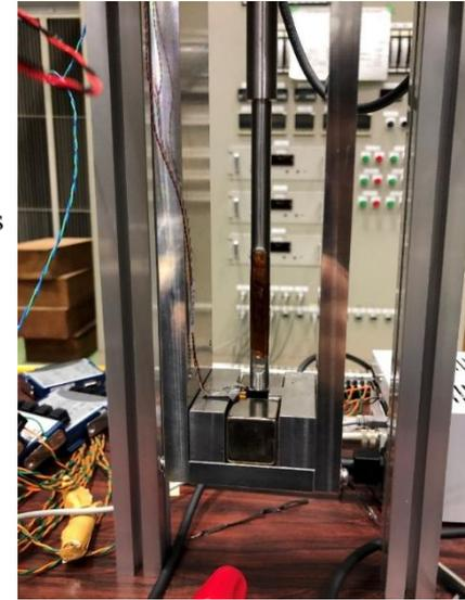
使用した線材： $I_c = 350 \text{ A/cm-w at } 77 \text{ K s.f.}$  上海超導社製
