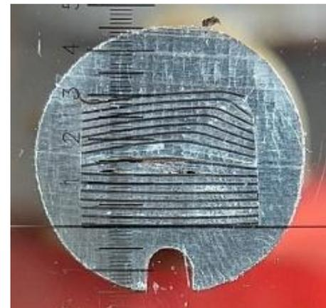
製作過程で内部の超伝導線材が褶曲
