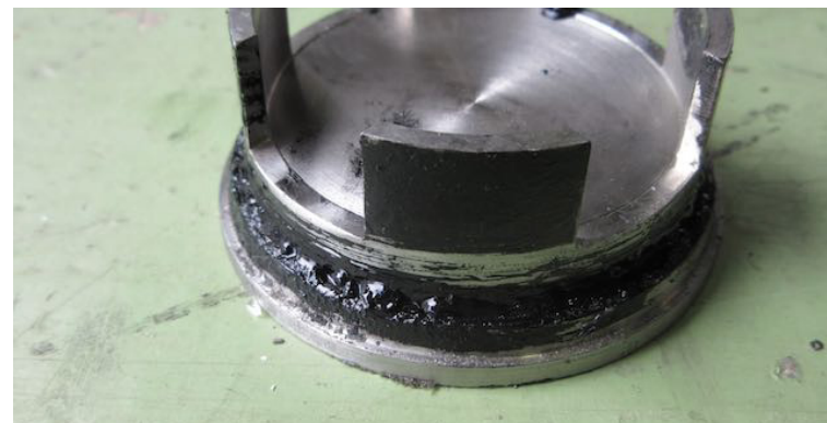
経年劣化(加水分解)によりドロドロに溶けたシールオフバルブのポリウレタン製O-ring
