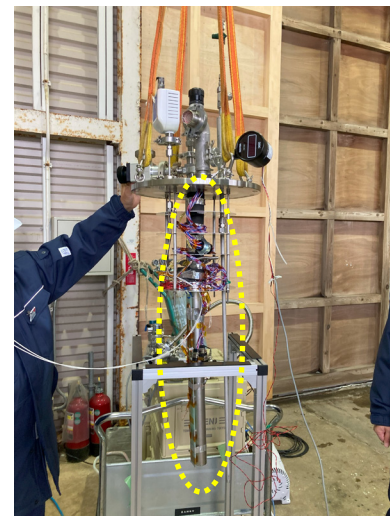
Case 1 液体水素中の供試体内に空気をリーク@JAXA能代ロケット実験場
