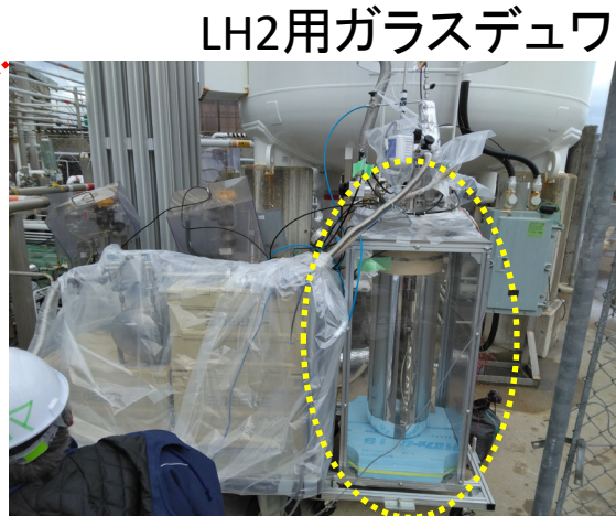
Case 1 液体水素中の供試体内に空気をリーク@JAXA能代ロケット実験場
