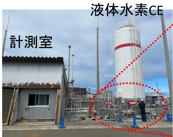
Case 1 液体水素中の供試体内に空気をリーク@JAXA能代ロケット実験場
