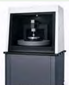
(2) 高温高真空 ナノインデント (3) スモールパンチ 試験システム (変形・破壊応力、 硬さ、弾性率)
